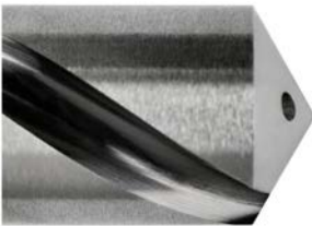
Bohrernut unzureichend poliert Rz=0,45 µm
