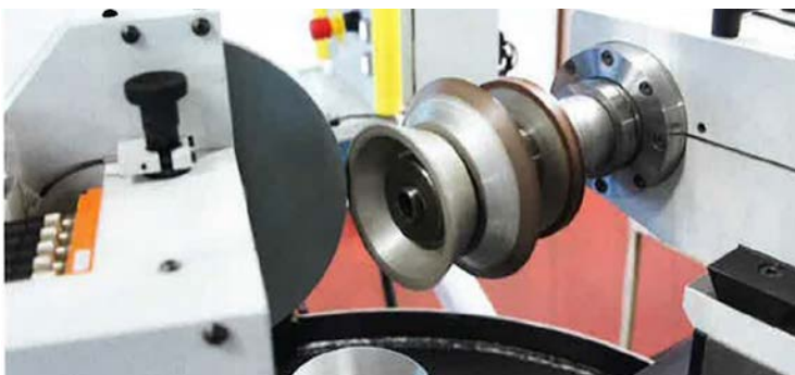
Abbildung 7: Abrichten auf externer Maschine.
